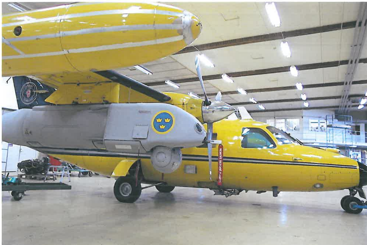
Under vingen på MU-2 hänger Ugglan SpaningsKapsel. Spaningskapseln är framtagen av AerotechTelub och används bland annat för att utbilda sensoroperatörer. FOTO: Fredrik Neumann, AerotechTelub.
