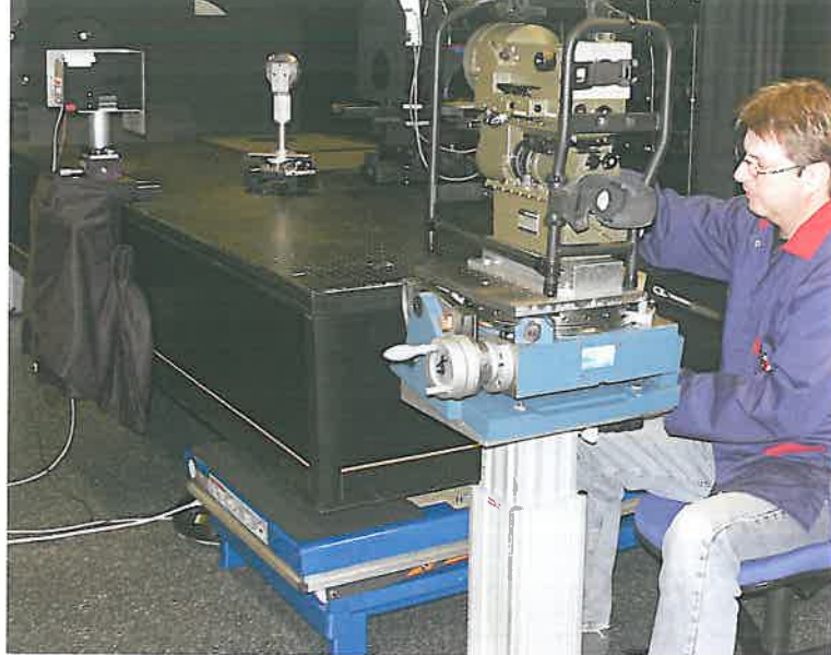
Jan Taavo systemtestar IR-sikte för robot 56 i den generella testbänken för IR-system.
